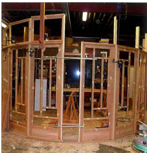
De bijzondere deur werd gemaakt naar een ontwerp van Victor Horta, maar met moderne details die voldoen aan de hedendaagse normen op het vlak van veiligheid, gebruiksgemak en duurzaamheid. Eerst werden er in het atelier heel wat werkzaamheden verricht, zodat de plaatsing op de werf in amper drie dagen voltooid was
