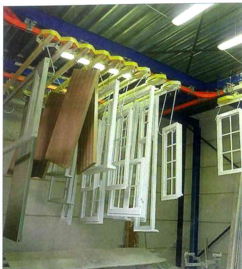
Een eigen lakkerij werd geïnstalleerd met een dorpelbak om de grondlaag aan te brengen
